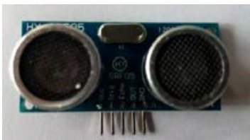
تصویر ماژول فاصله سنج SRF-05 آلتراسونیک.
