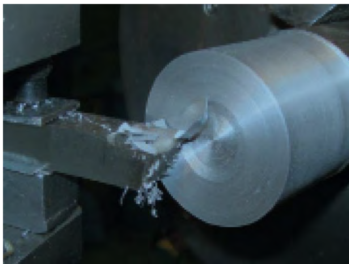
شکل ۲-۲۹: تراشکاری قطعات کوتاه
