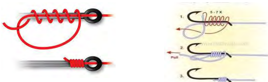
شکل ۲۴- دو نمونه گره برای بستن نخ مونوفیلament به قلاب ماهیگیری
