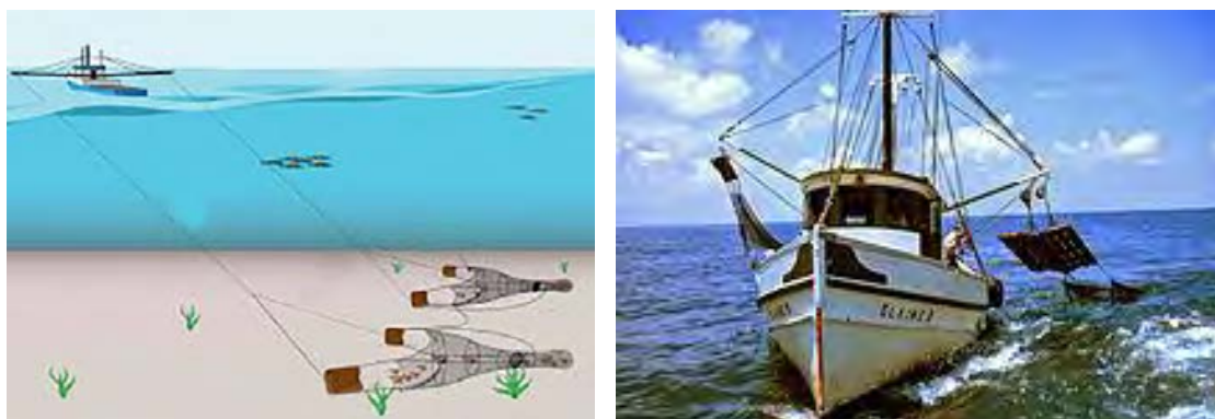
شکل ۵۲- کشتی صیادی ترالدو بازویی در حین عملیات تور اندازی و موقعیت تورها در حین صید
