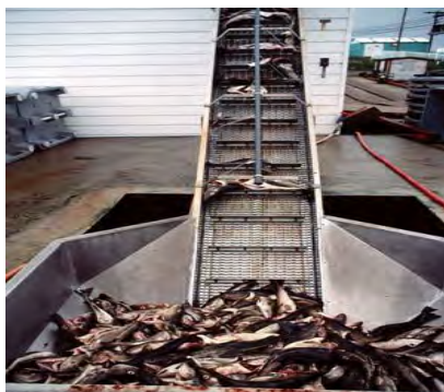
شکل ۱۶- کاربرد تسمه نقاله حمل ماهی در داخل شناور
