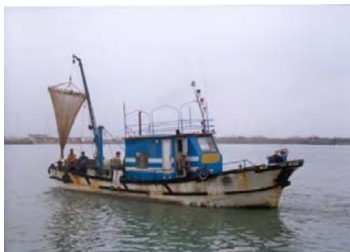
شکل ۴۱- شناورهای ماهیگیری مجهز به تور قیفی ویژه صید ماهی کیلکا در دریای خزر
