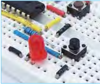
شکل ۸۸ - ۱- اتصال قطعات روی بردبرد
