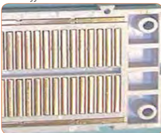
شکل ۹۰ - ۱- اتصالات داخلی برد بُرد
