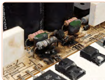
شکل ۲۳-۴ - آسیب قطعات در یک برد
