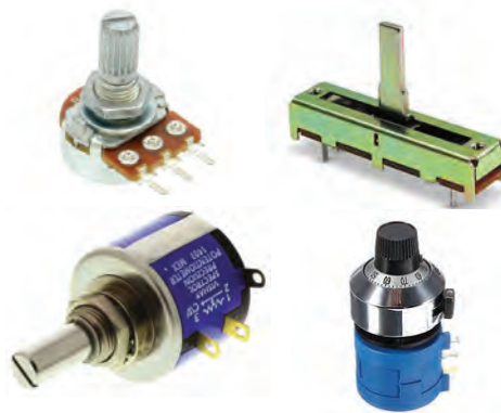
شکل ۹۴-۱- چند نمونه مقاومت‌های متغیر معمولی با محور دوار و کشویی
