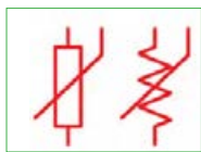
شکل ۹۷-۱- چند نمونه مقاومت‌های تابع ولتاژ و نماد آن
