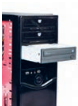
شکل ۵۰- قراردادن دیسک گردان نوری در کیس
