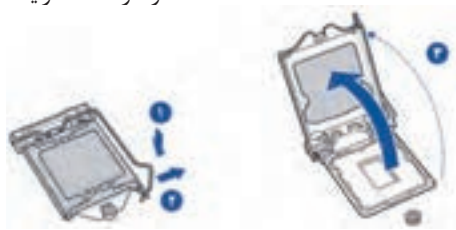
شکل ۳۲- آزاد کردن نگهدارنده سوکت
