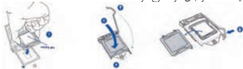
شکل ۳۵- مراحل قراردادن پردازنده در سوکت
