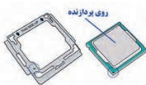
شکل ۳۴- نشانه روی پردازنده و سوکت
