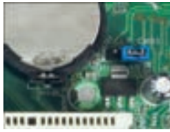
شکل ۱۴ - جامپر Clear CMOS
