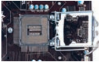
شکل ۹- سوکت پردازنده
