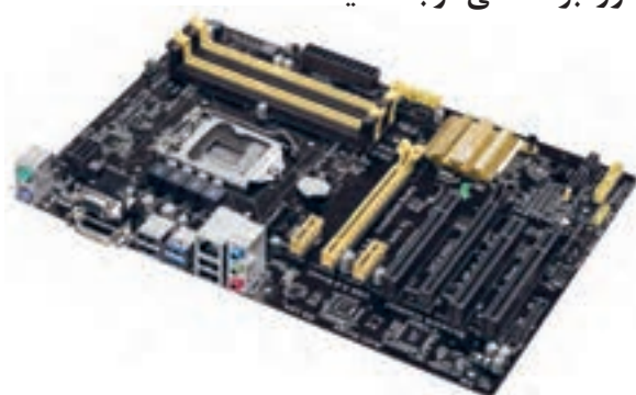
شکل ۸ - برد اصلی با فرم فاکتور ATX
