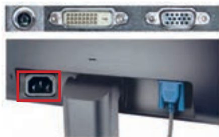
شکل ۴- محل اتصال کابل های صفحه نمایش
