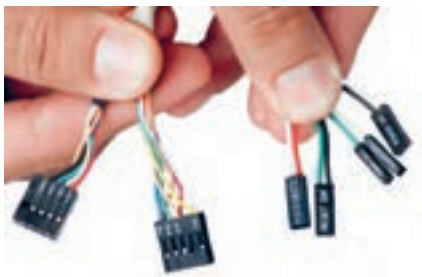
شکل ۴۴- کانکتورهای پنل جلوی کیس
