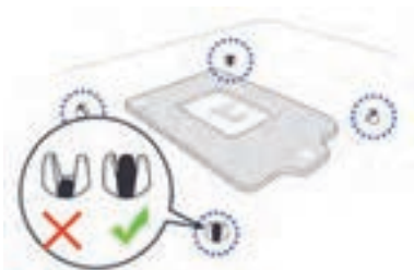
شکل ۳۸- پایه‌های سیستم خنک‌کننده در پشت برد اصلی
