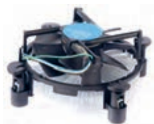
شکل ۳۶ - سیستم خنک‌کننده پردازنده
