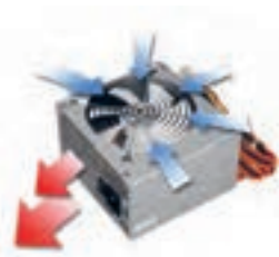
شکل ۲۳- جهت تهویه هوا در منبع تغذیه
