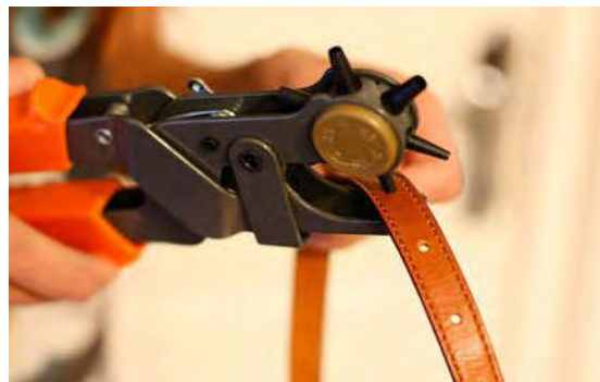
الف) شکل ۳-۱۹ پرچ سوراخ کمر بند
