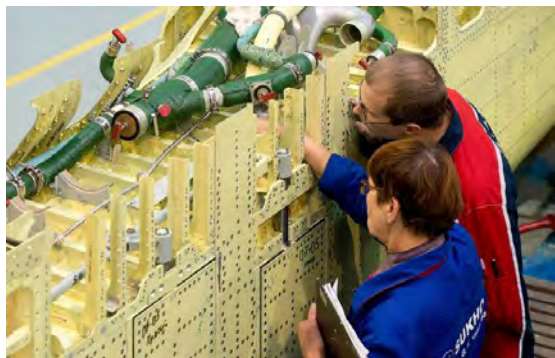
شکل ۳-۱۷ بازدید سازه پرچ کاری شده
