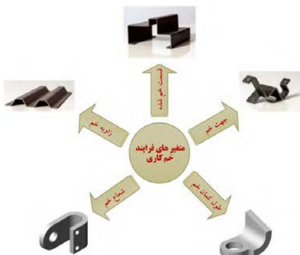
شکل ۳-۲ متغیرهای خم کاری
