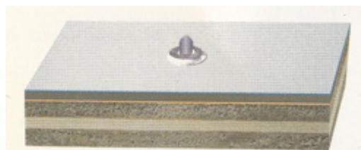
شکل ۳-۲۶ بیرون زدن میخ پرچ
