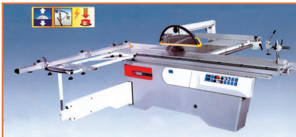
شکل ۴-۲۹- دستگاه اره گرد خطزن تیغه اتوماتیک برش صفحات MDF
