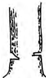
شکل ۱۶-۲- مرحله دوم، عمل برش درخت در جهتی که باید بر روی زمین بیفتد.
