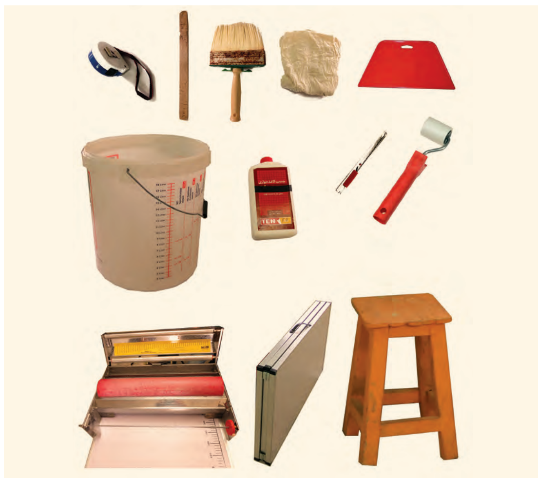
شکل ۶۲-۳- ابزار و تجهیزات کارگاه اجرای کاغذ دیواری
