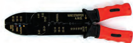
شکل ۱-۲۲ - یک نمونه دستگاه چند کاره
