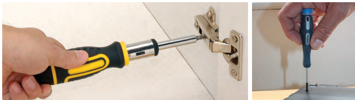
شکل ۳۱-۱- چگونگی صحیح در دست گرفتن پیچ گوشتی
