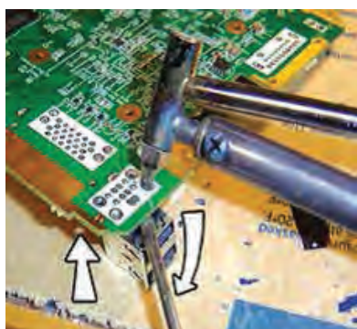
شکل ۸۷-۱- استفاده از قلع کش حرارتی
