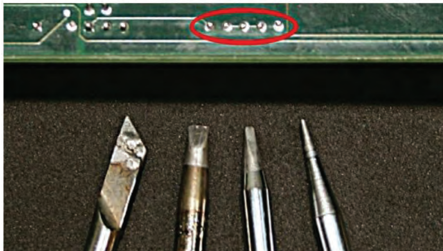
شکل ۱-۳۷ - چهار نمونه نوک هویه
