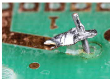
شکل ۹۲-۱- (اینفو گرافیک) نمونه‌هایی از لحیم مشکل دار
