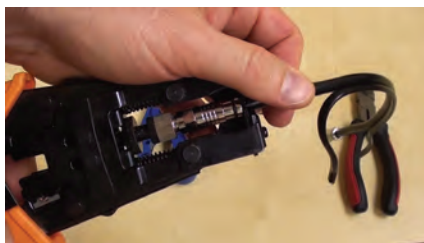
شکل ۱-۷۲- دو نمونه دستگاه پرچ BNC
