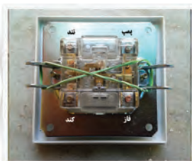
شکل ۲-۸۰ - ساختمان داخلی کلید کولر
