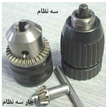
شکل ۲۱-۲ دو نمونه سه نظام
