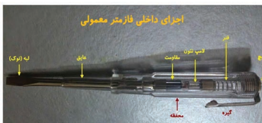
شکل ۳۷-۲- ساختمان داخلی فازمتر
