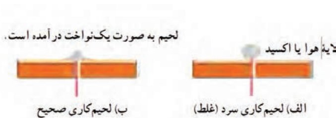
شکل ۵۰-۱- لحیم‌کاری صحیح و غلط
