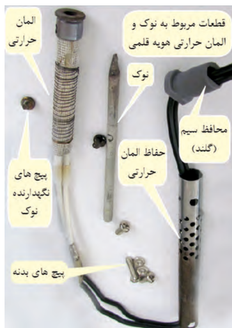
شکل ۹۵-۱ - مراقبت از اجزاء داخلی هویه قلمی
