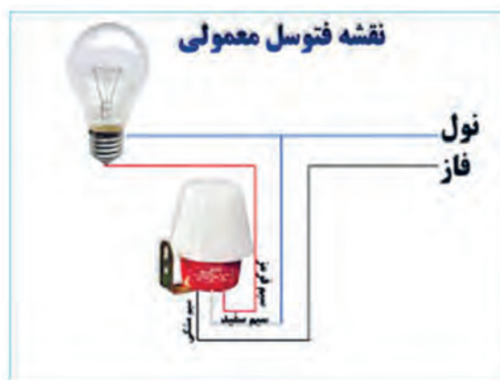
شکل ۶۸-۲- یک نمونه فتوسل
