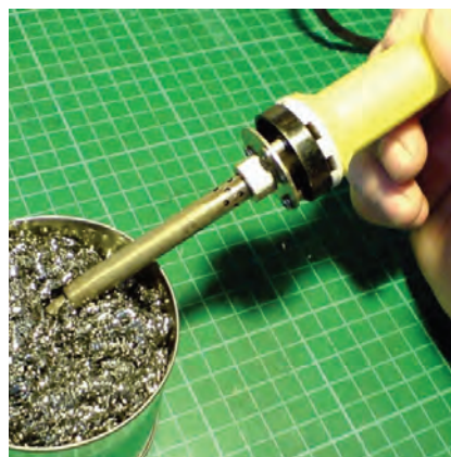
شکل ۴۲-۱- تمیز کردن نوک هویه با اسفنج مخصوص
