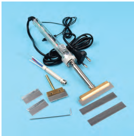
شکل ۴۰-۱ یک نمونه هوپه با نوک پارویی
