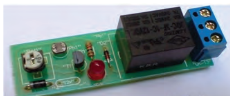
شکل ۲-۶۶ - یک نمونه فتوسل
