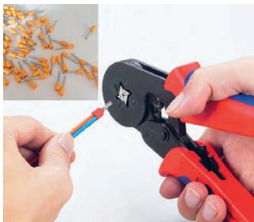
شکل ۷-۲ - دستگاه پرس سرسیم های پرسی
