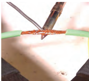
شکل ۴۹-۱- لحیم یک اتصال با سیم افشان
