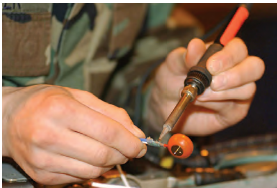
شکل ۵-۱- نمونه‌هایی از لحیم‌کاری نرم
