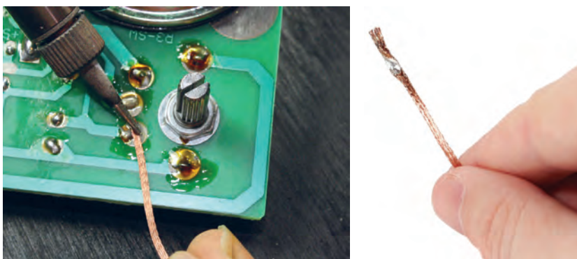
شکل ۸۰-۱ - برداشتن قلع از روی فیبر
