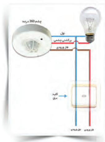
شکل ۷۱-۲- یک نمونه نقشه رله چشمی راه پله
