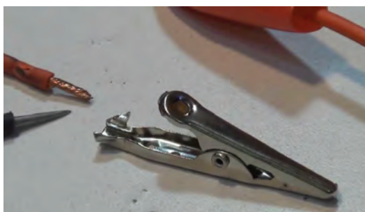
شکل ۶۶-۱- گیره سوسماری بدون روکش حرارتی
