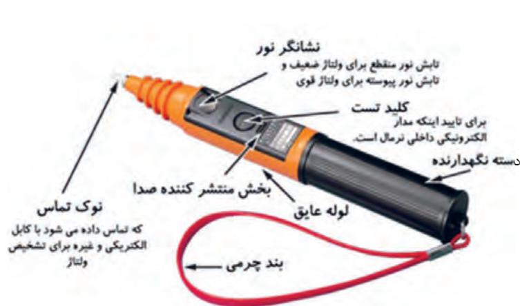
شکل ۳۸-۲- ساختمان داخلی فازمتر دیجیتالی
