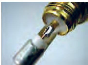
شکل ۱-۷۰- اتصال کابل کوآکسیال به فیش آنتن
