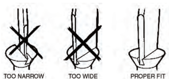
شکل ۲۹-۱- انتخاب آچار مناسب مانع خرابی گل پیچ می شود
