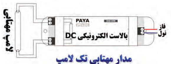
شکل ۶۱-۲- لامپ فلورسنت با انواع بالاست
