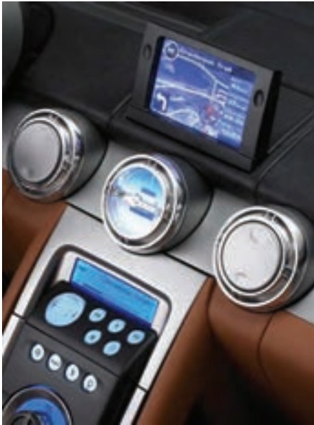
شکل ۱۹۵-۲- دستگاه مانیتور نصب شده روی خودرو که می‌تواند در نقش عیب‌یاب نیز عمل کند.
