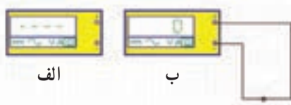
شکل ۲-۷۹ - آزمایش اطمینان از سلامت اهم متر
