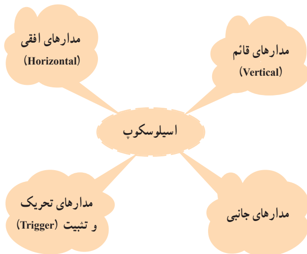
شکل ۱۲۰-۲- مدارهای موجود در اسیلوسکوپ
