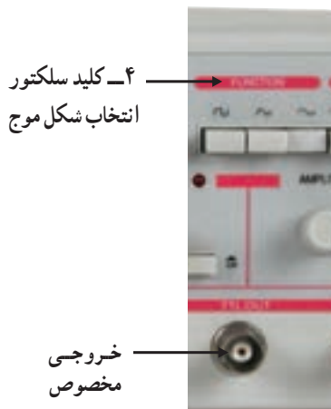
شکل ۱۰۱-۲ کلید سلکتور انتخاب شکل موج
