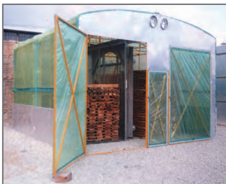
کوره خشک کن چوب با سیستم هوای گرم خورشیدی
