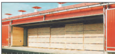
کوره خشک کن چوب با سیستم گردش هوای گرم از بالا به پایین
