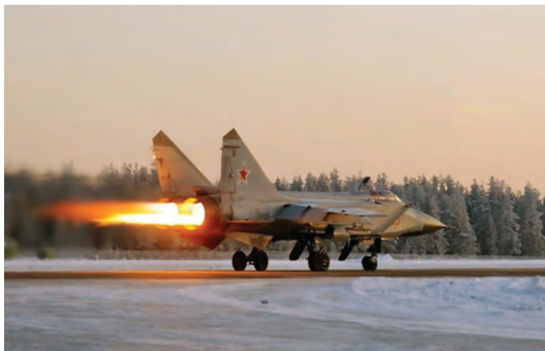
شکل ۲۸- برای تحمل دماهای بالای گازهای خروجی موتور جت به ابر آلیاژها و مواد دیرگداز نیاز است
