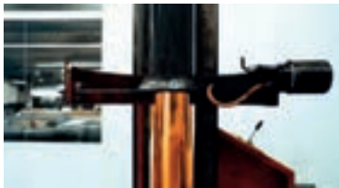
۲. موم اندود کردن سیلندر با ماده حساس کننده
