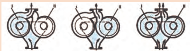
پمپ یک در حال کار
