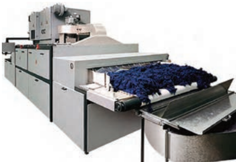
یک عدد ماشین خشک‌کن مجهز به سیستم خشک‌کن رادیو فرکانسی
