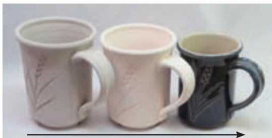
انقباض لیوان سرامیکی از مرحله خشک‌کردن به پخت بیسکویت و پخت لعابی
