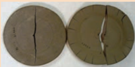
تأثیر اندازه ذرات بر رفتار خشک شدن
