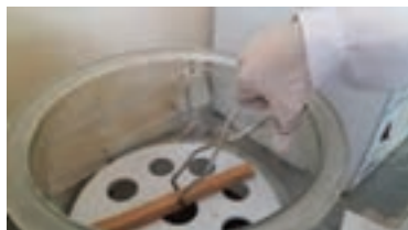
انتقال نمونه‌های استحکام خمشی خشک از خشک‌کن به دسیکاتور
