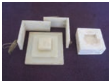
قالب و مادر قالب نمونه ساز انقباض
