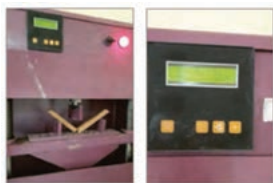
اندازه‌گیری استحکام خمشی خشک نمونه‌ها
