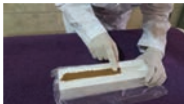
ساخت نمونه استحکام خمشی و کدگذاری
