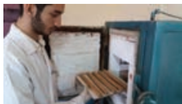
انتقال نمونه‌های استحکام خمشی خشک به کوره و تنظیم دمای کوره
