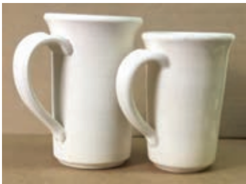
انقباض حدود ۱۴ درصدی یک بدنهٔ پرسلان بعد از پخت لعابی
