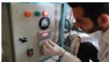
انتقال نمونه‌های استحکام خمشی خشک به کوره و تنظیم دمای کوره
