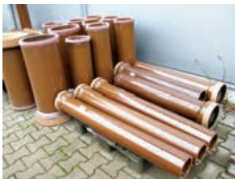
لوله‌های سرامیکی فاضلاب با لعاب نمکی
