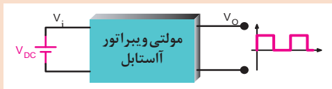
بلوک دیاگرام مولتی ویراتور آستابل و موج خروجی آن
