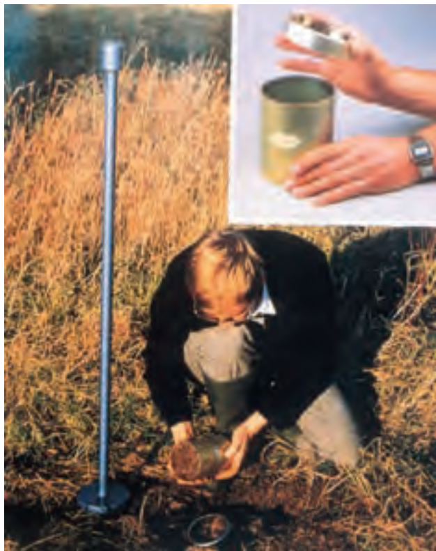
شکل ۱۶- ۱ نمونه برداری از خاک با سیلندر
