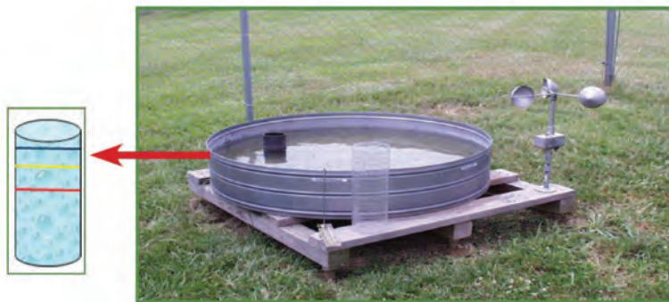
تشت تبخیر و اجزای آن (تشت، استوانه کوچک درون تشت و پیمانه)
