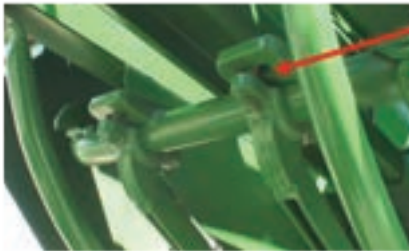
پیچ کشویی برای تنظیم موقعی سوزن‌ها در شیار مسیر حرکتی خود
