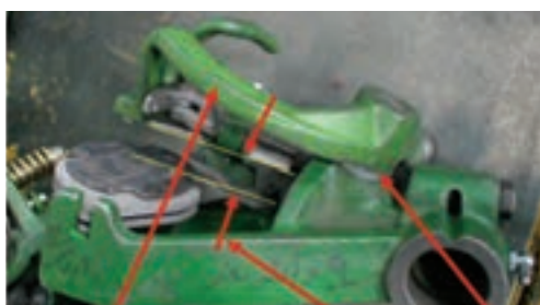
واشر این فاصله باید ۴ تا ۵ میلی‌متر باشد بازوی برش
