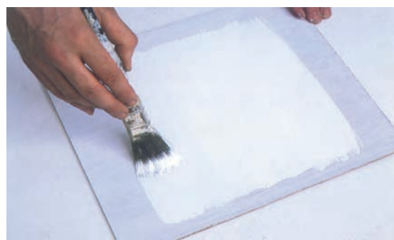
تصویر ۲- تخته چند لایه که به وسیله ماده نفوذناپذیر پوشیده شده است. سعی کنید ماده نفوذناپذیر را یک بار از یک سمت و پس از خشک شدن، از سمت دیگر بر روی سطح، بمالید.
