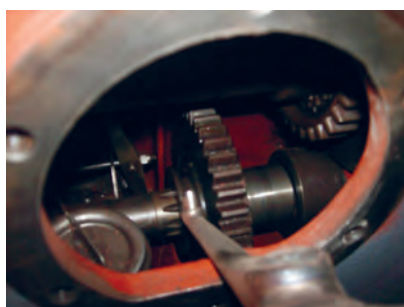
شکل ۲۱. محور تواندهی در حالت موتور گرد
