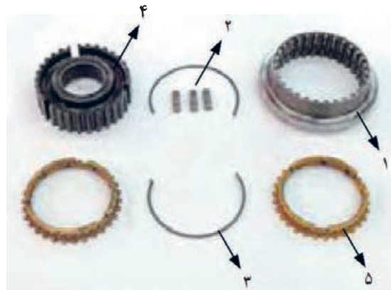
۱- کشویی، ۲- خار، ۳- فنرهای حلقه‌ای، ۴- تویی، ۵- دنده برنجی (حلقه سنکرونیزه)
