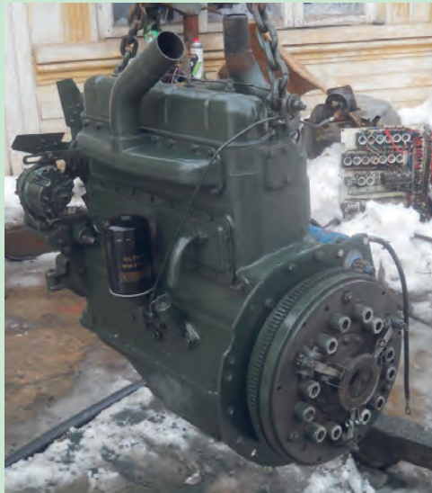
شکل ۲۴. پیاده کردن موتور تراکتور U650
