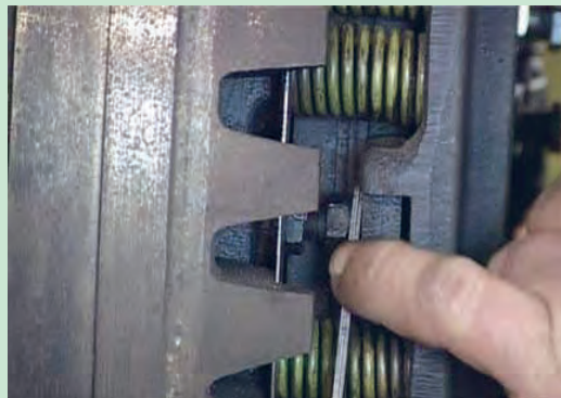
شکل ۳۹. تنظیم کلاچ محور تواندهی
