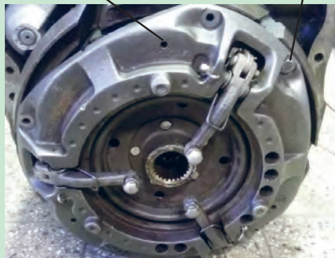
شکل ۲۵. جدا کردن مجموعه کلاچ از فلاپویل
