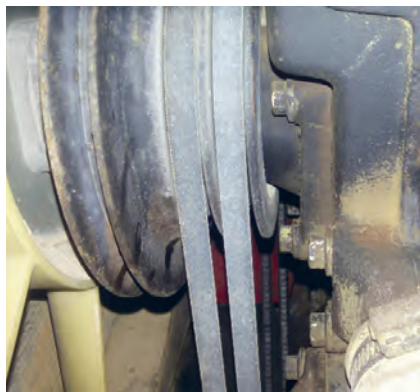
شکل ۷. استفاده از دو تسمه در تراکتور MF۳۹۹
