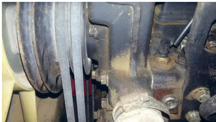
شکل ۱۰. محل فشنگی آب روی تراکتور MF۳۹۹
