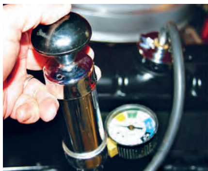
شکل ۶. آزمایش نشت یابی تحت فشار
