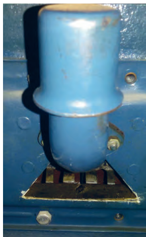
۴۰. تهویه محفظه کارتر در تراکتور U650
