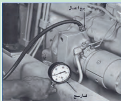
شکل ۵°. فشار سنجی مدار روغن کاری
