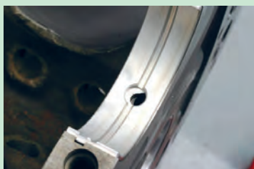
شکل ۹۳. قرار گرفتن سوراخ روغن مقابل هم
