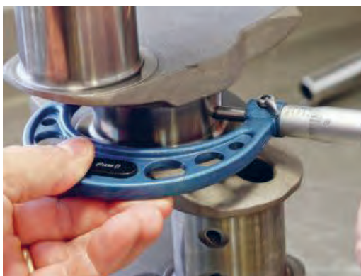
شکل ۷۱. اندازه گیری قطر میل لنگ
