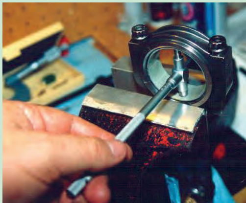
شکل ۸۳. کنترل بیضی شدن سر بزرگ شاتون
