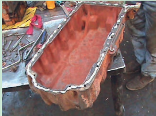
شکل ۱۱۴. جسابندن واشر کارتر
