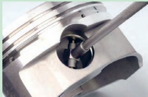
شکل ۸۱. اندازه گیری لقی گزن بین در پیستون
