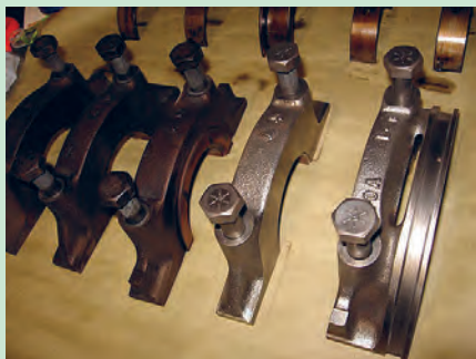
شکل ۴۸. برداشتن کپه های یاتاقان و چیدن آنها
