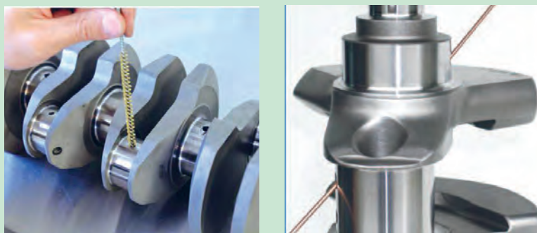
شکل ۶۰. تمیز کردن مجاری میل لنگ
