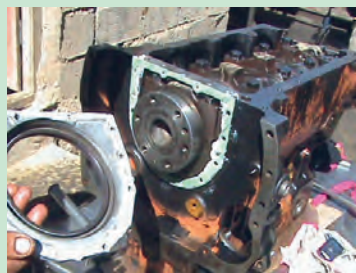
شکل ۹۸. جا زدن و بستن کاسه نمد ته میل لنگ
