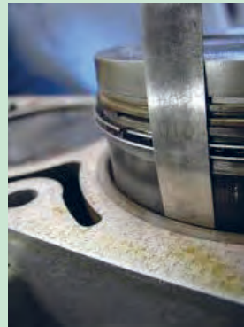
شکل ۷۷. اندازه گیری لقی پیستون در سیلندر با فیلر
