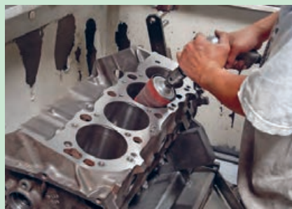
شکل ۳۹. ترمیم لبه بالای سیلندر
