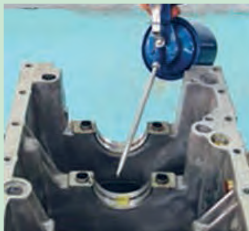
شکل ۹۵. روغنکاری یاتاقان ها قبل از نصب
