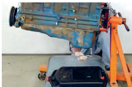
شکل ۳۳. موتور نصب شده روی استند
