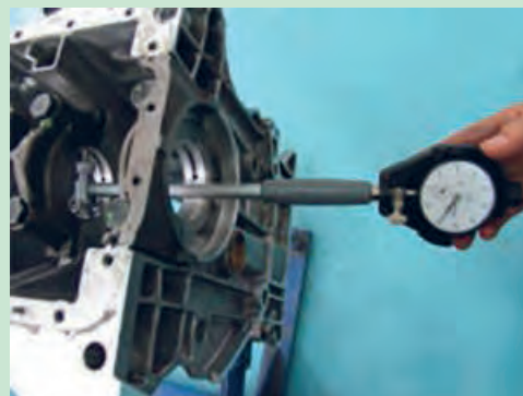
شکل ۶۳. کنترل دو په‌نی تکیه‌گاه‌های میل‌لنگ
