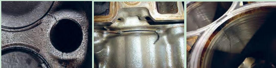
شکل ۶۲. ترک در سیلندر و بلوکه سیلندر
