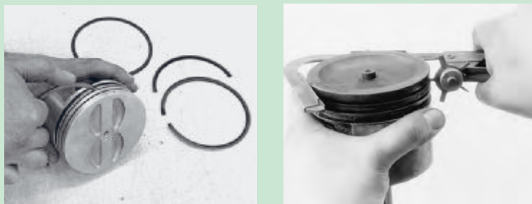
شکل ۵۸. روش های تمیز کردن شیار رینگ پیستون
