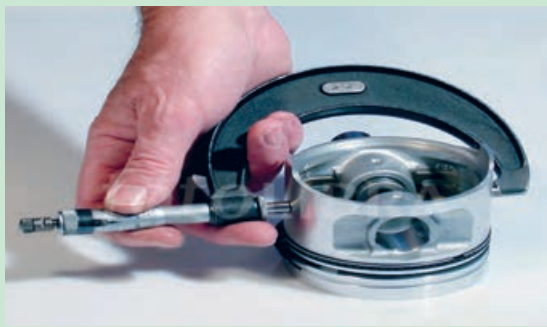
شکل ۷۵. اندازه‌گیری قطر پیستون با میکرو متر
