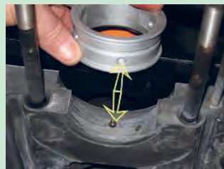
شکل ۹۳. قرار گرفتن سوراخ روغن مقابل هم
