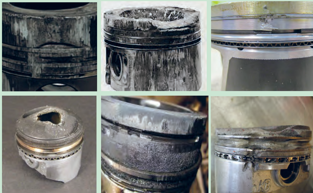
شکل ۷۴. نمونه ای از پیستون های معیوب
