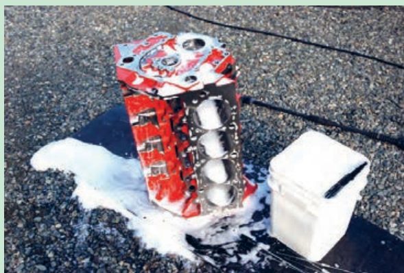
شکل ۵۶. تمیز کردن قطعات با فشار آب گرم و مواد پاک کننده
