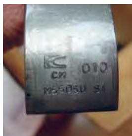
شکل ۲۳. تغییر ضخامت یاتاقان در سایزهای مختلف
