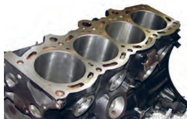
الف- سیلندر یکپارچه با بلوک سیلندر
