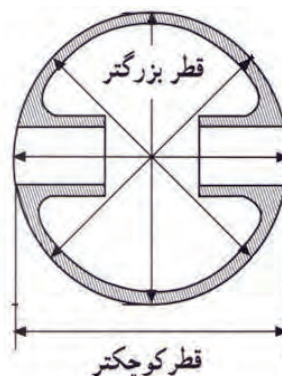
شکل ۷. اندازه قطرهای پیستون
