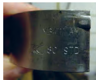
شکل ۲۳. تغییر ضخامت یاتاقان در سایزهای مختلف
