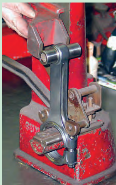
شکل ۸۲. پیچیدگی شاتون، اندازه گیری و اصلاح آن
