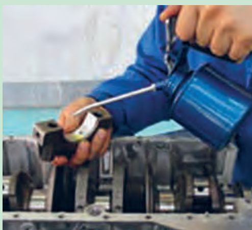
شکل ۹۵. روغنکاری یاتاقان ها قبل از نصب
