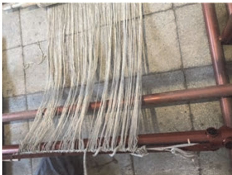
شکل ۴۲- ته دوزی کردن تارها
