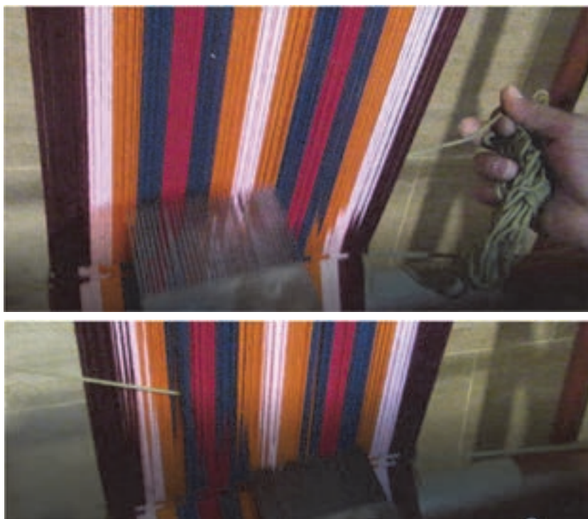
شکل ۲۲- کوبیدن پود در هنگام بافت
