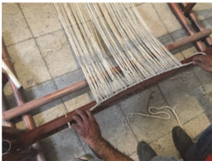
شکل ۴۱- بستن چله بر روی تیر پایین
