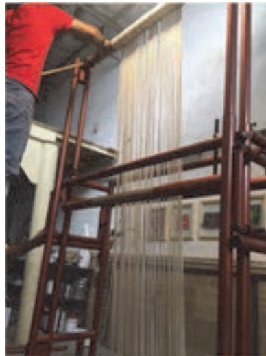
شکل ۴۵- برگرداندن چله‌ها بر روی تیر بالا
