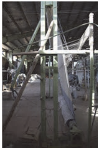
شکل ۴۸- دستگاه متحرک با اتصالات پیچ و مهره
