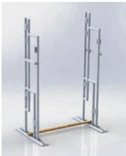
شکل ۵۷-قرار دادن مهار پایین
