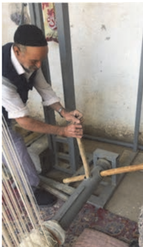
شکل ۶۶- تنظیم فشار چله‌ها
