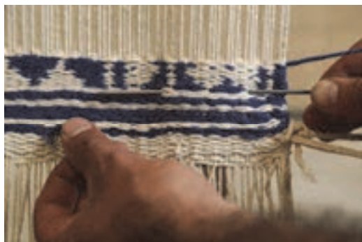
شكل ۷۵- قرار دادن سوزن مهيار در داخل بافته
