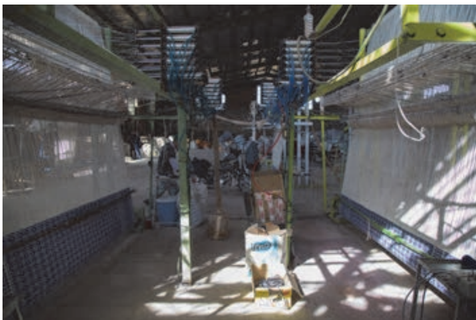
شکل ۲۷- دستگاه مکانیکی بافت زیلو
