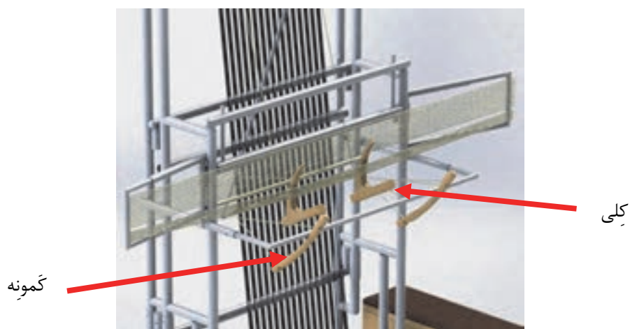
شکل ۵۵- قسمتی از دستگاه بافت زیلو و اجزای آن
