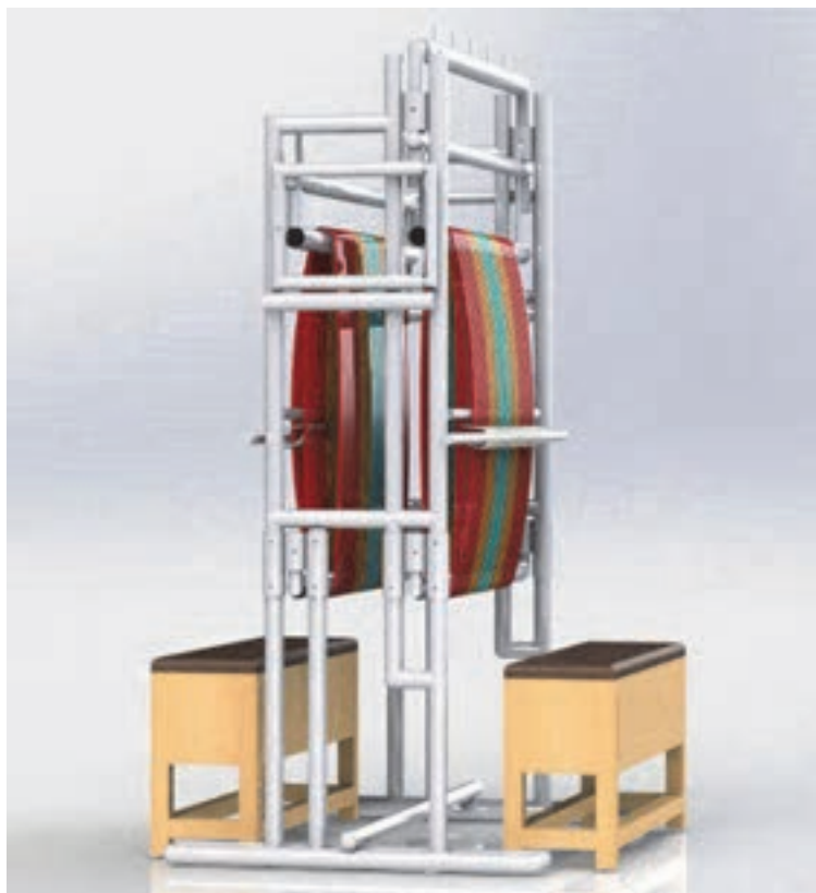
شکل ۱۴- دستگاه آموزشی بافت با قابلیت چله‌کشی مستقل در دو طرف دستگاه
