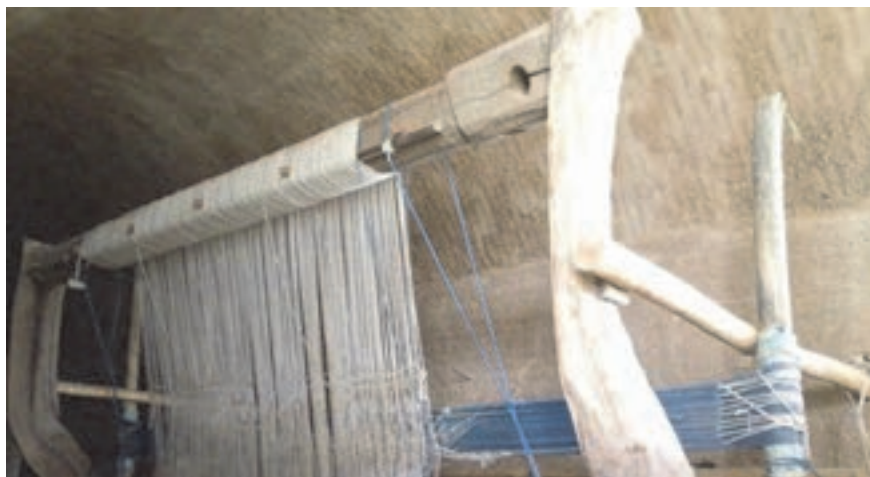
شکل ۳۰- تیر بالا در دستگاه زیلوبافی
