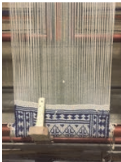
شکل ۷۹- جمع کردن زیلو بر روی تیر پایین
