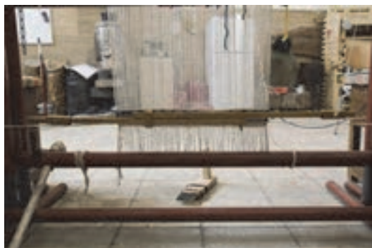
شكل ۷۷- مهيار پهناوند و بستن آن به كار
