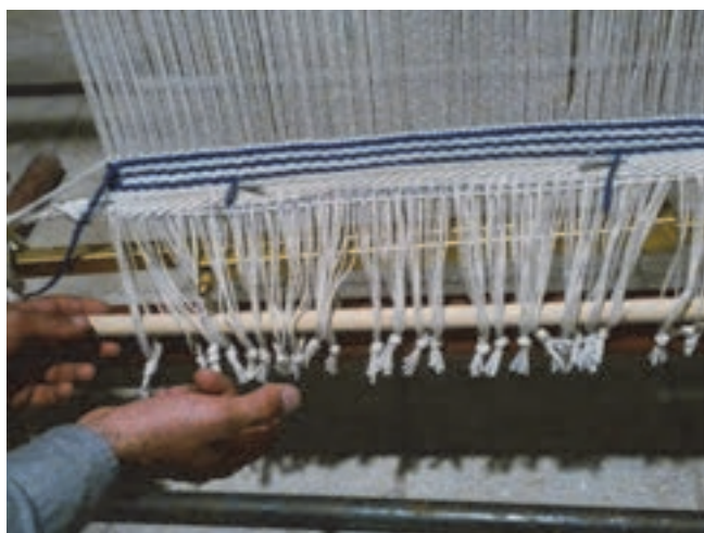
شکل ۸۹- قرار دادن چوب مهار
