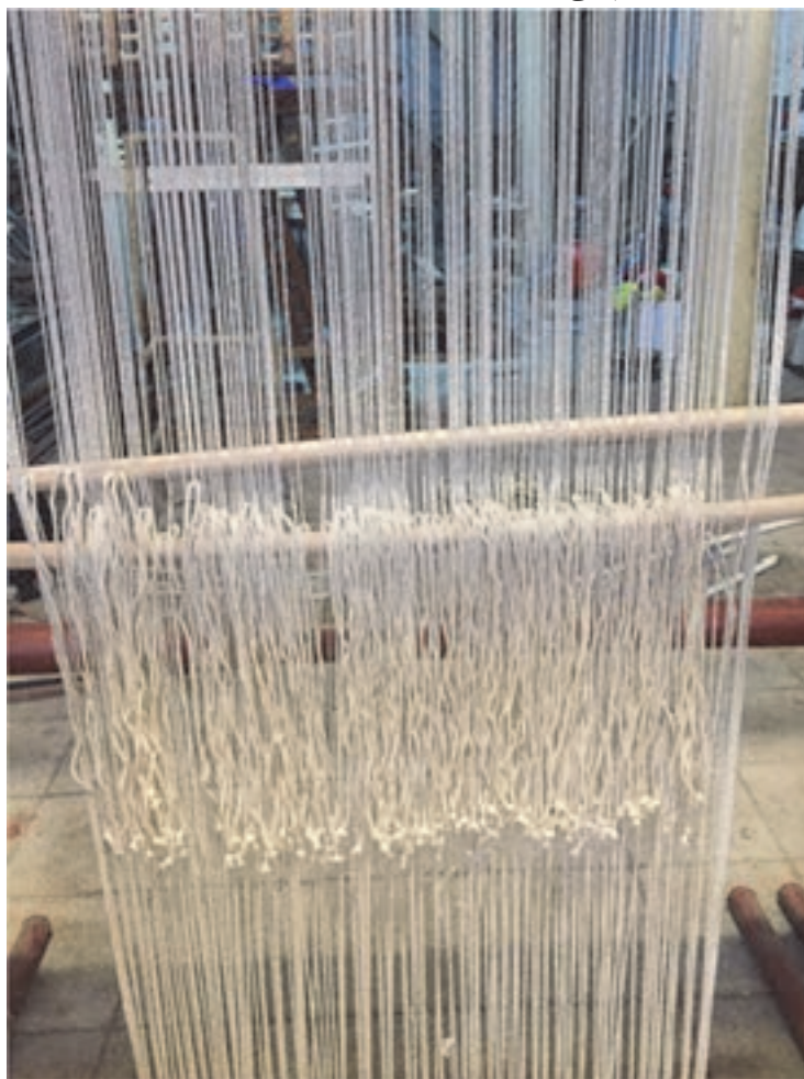
شکل ۵۴ - قرار دادن گرت‌های نقش بر روی چله‌ها
