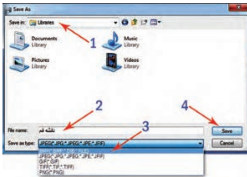
شکل ۴-۷۵- پنجره مخصوص Save As و مراحل ذخیره‌سازی مجدد
