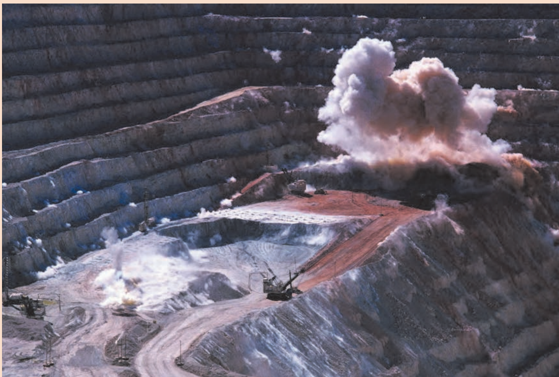
عملیات چال‌زنی و آتشکاری در معدن
