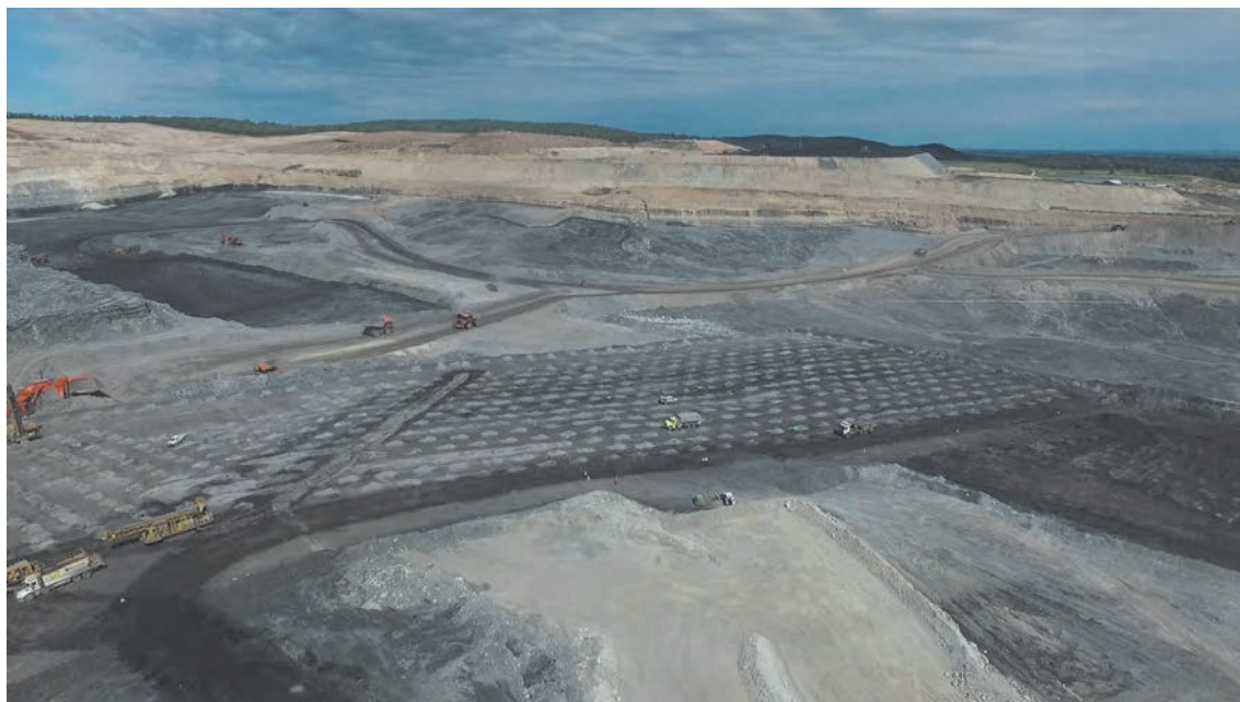
شبکه چال آتشیاری حفر شده
