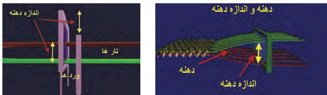
شکل ۴۴ تشکیل دهنه و اندازه آن
