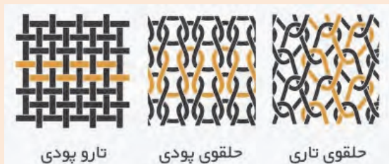
شکل ۵ مقایسه سه ساختار بافت تار-پودی، حلقوی پودی و حلقوی تاری
