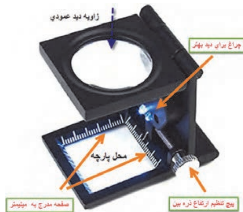
شکل ۱۶ نحوه استفاده از پود شمار
