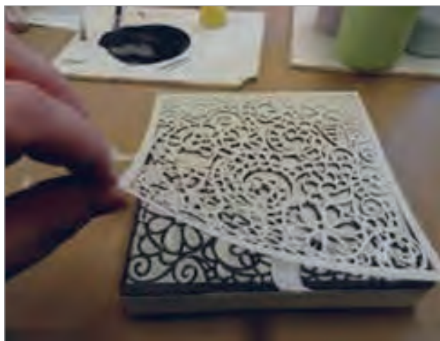
شکل ۳۴- لعاب زنی با روش چاپ استنسیل
