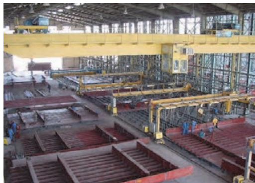
شکل ۴- اسمبل کردن بلوک کشتی
