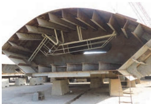
شکل ۶- اتمام جوش کاری بلوک کشتی
