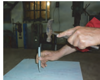
شکل ۱۳- استفاده از سنبه برای نشانه‌گذاری
