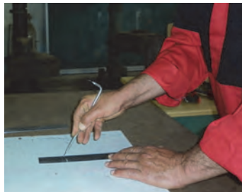
شکل ۱۴- استفاده از خطکش و سوزن خطکش
