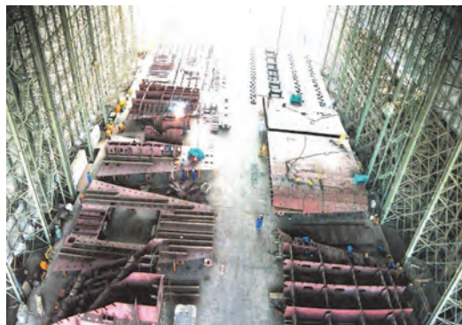
شکل ۵- جوش کاری بلوک کشتی
