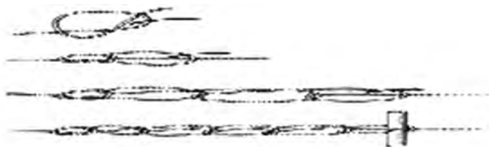
نحوه زدن گره زنجیری کوتاه کننده طناب
