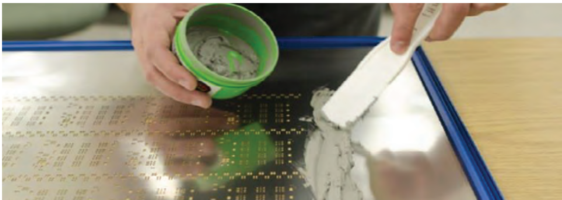
شکل ۱۲-۳ خمیر اندود کردن لحیم به کمک شابلون
