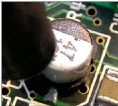
شکل ۲-۳ دمونتاز خازن سرامیکی و الکتrolیت SMD
