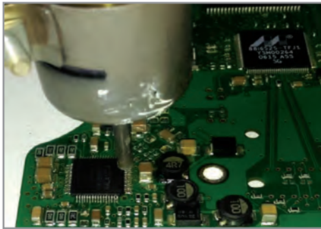
شکل ۲-۴ دمونتاز آی سی های چهار طرفه (خرچنگی)
