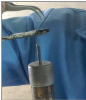
شکل ۲-۸ حرارت از زیر برد
