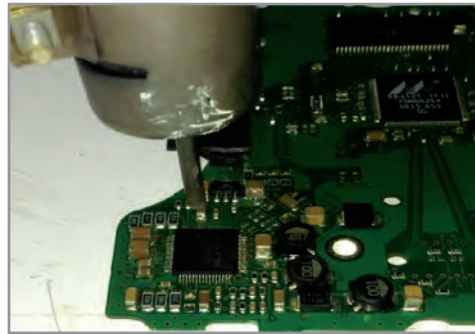
شکل ۲-۴ دمونتاز آی سی های چهار طرفه (خرچنگی)
