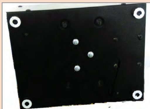
شکل ۱-۴ سه پیچ قفل کننده کمپرسور به بدنه
