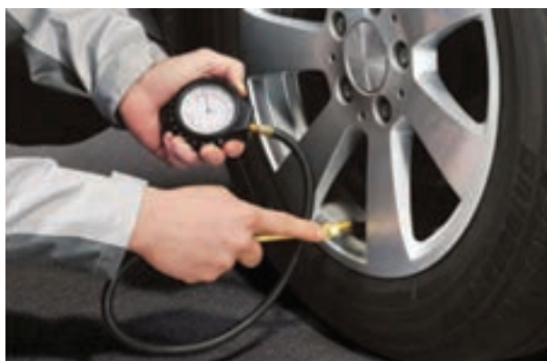
شکل ۱۰- اندازه‌گیری و تنظیم فشار باد تایر
