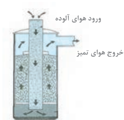
مکانیزم تصفیه هوا توسط فیلتر هوای روغنی
