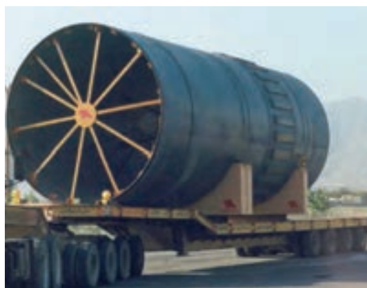
شکل ۵۸- روش مهار بار خاص توسط زین
