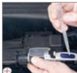
شکل ۱۰- اندازه گیری الکترولیت باتری
