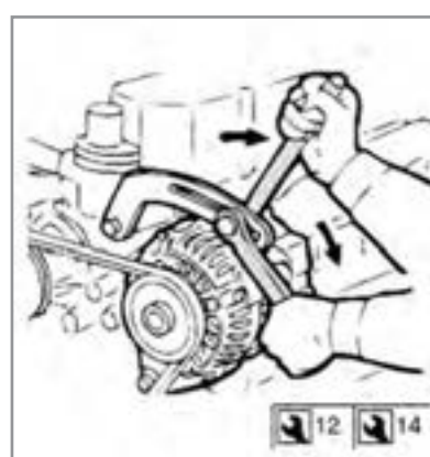
تنظیم کردن میزان کشش تسمه
