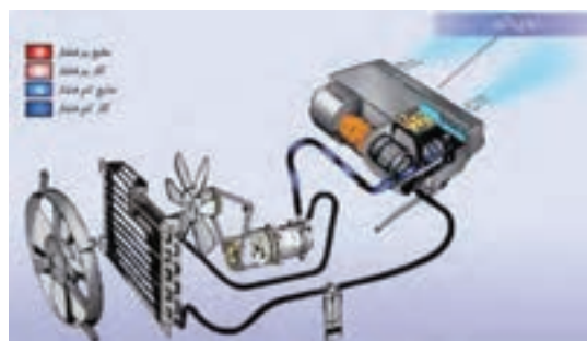
شکل ۲۵ - مدار و اجزای کولر وسیله نقلیه
