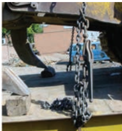
شکل ۲۷- بستن قسمت‌های مفصلی ماشین آلات راه‌سازی
