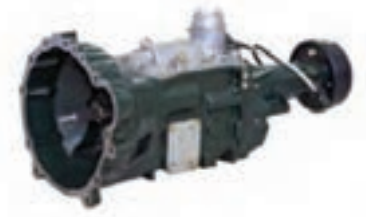
شکل ۲۶- نمای یک گیربکس نارگان جاده ای
