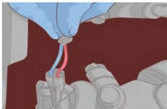
شکل ۳۰- سیم‌کشی کمپرسور
