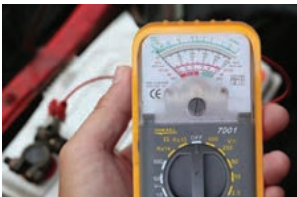
شکل ۴۰- تست باتری
