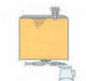
شکل ۲۳- تخلیه آب و رسوبات ته‌نشین شده در مخزن سوخت
