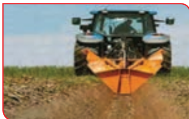
ساختن جوی های آبیاری
