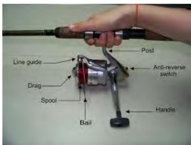
شکل ۳۴- قلاب و دسته همراه با وینچ نخ جمع کن مخصوص صید تفریحی- ورزشی
