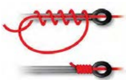
شکل ۲۴- دو نمونه گره برای بستن نخ مونوفیل‌مانت به قلاب ماهیگیری
