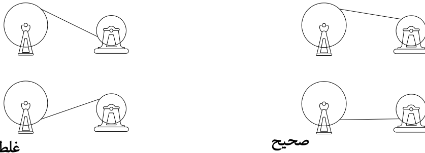
شکل ۲۰- اصول پیچاندن طناب‌های سیمی از روی یک قرقره به قرقره دیگر
