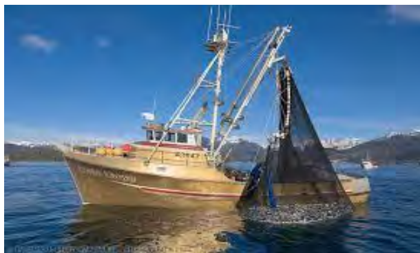
شکل ۶۳- خارج نمودن کامل تور گردان پیاله ای از دریا و انتقال آن بر روی عرشه توسط کشتی پورس سینر
