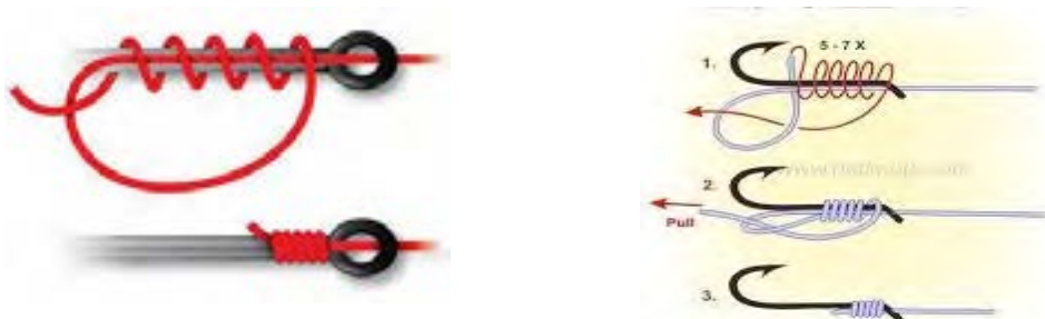
شکل ۲۴- دو نمونه گره برای بستن نخ مونوفیل‌مانت به قلاب ماهیگیری
