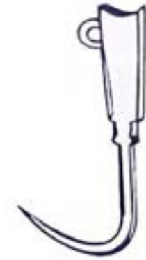
شکل ۲۶- قلاب بدون خار، برای صید تون ماهیان در روش قلاب و چوب دستی
