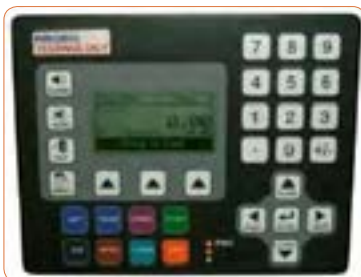
شکل ۴۰- نمونه‌ای از صفحه کنترل دستگاه بوبین پیچ
