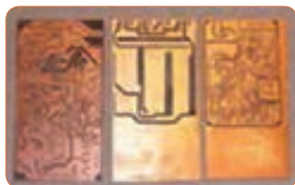
شکل ۱۱- انتقال طرح روی فیبر
