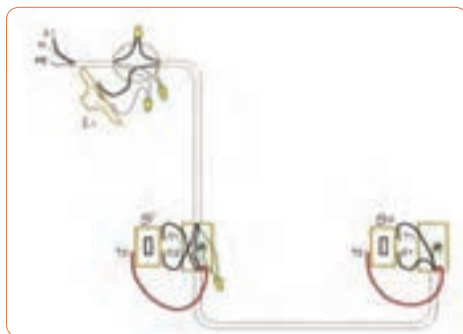
شکل ۱۸- مدار کلید تبدیل (برق از چراغ)
