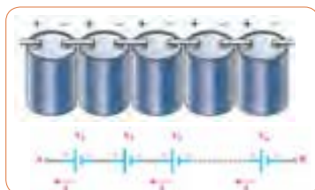
شکل ۲۴- اتصال سری پیل‌ها
