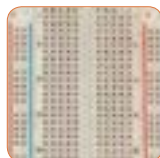
شکل ۳۶- بُرد بُرد و سوراخ‌های آن
