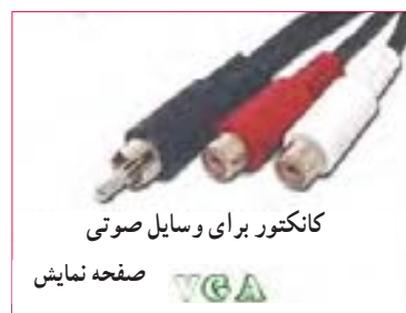
شکل ۱۷-۶ انواع کانکتور وسایل صوتی و تصویری
