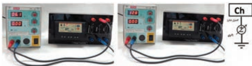
شکل ۱۸- تست کنترل شارژ
