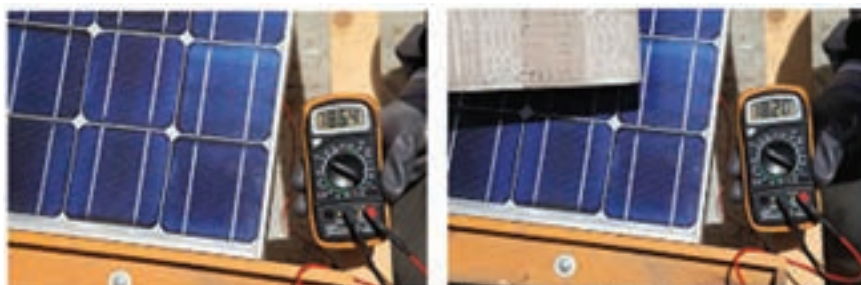
شکل ۷-الف - اثر سایه بر ولتاژ بی‌باری
