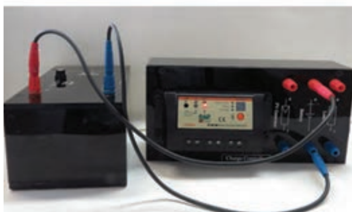
شکل ۱۱- باتری کاملاً شارژ نیست
