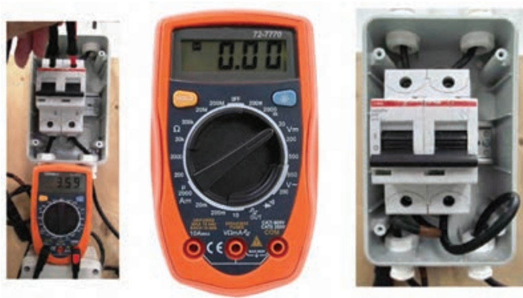
شکل ۱۰- اندازه گیری جریان اتصال کوتاه با مولتی متر
