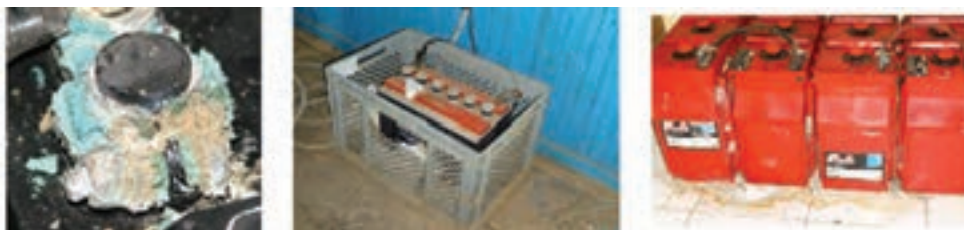
شکل ۲۱- سولفاته و نشستی باتری
