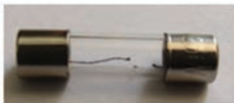
شکل ۱۶ - فیوز آسیب دیده است.
