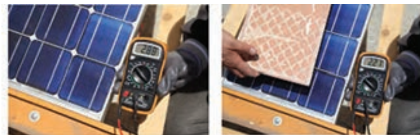
شکل ۷-ب - اثر سایه بر جریان اتصال کوتاه
