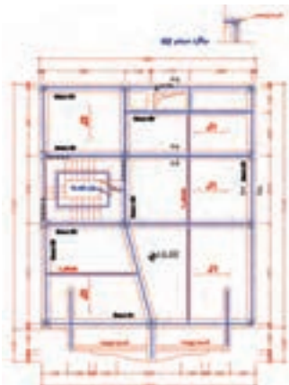
شکل ۱۴- نقشه اجرای همبندی سقف‌های ساختمان
