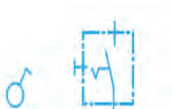
شکل ۲-۱۶- علائم اختصاری کلید یک پل
