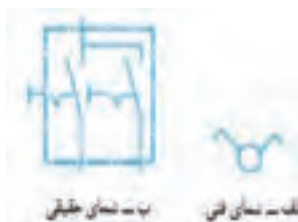
شکل ۲-۱۵- علامت اختصاری کلید دبل
