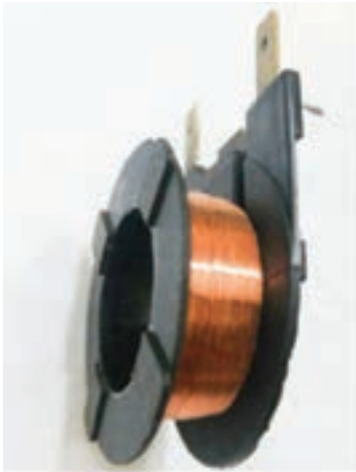
شکل ۲- سیم پیچ داخل موتور
