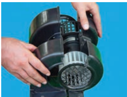
شکل ۴-۴۰- جدا کردن محفظه‌ی نگهدارنده‌ی موتور
