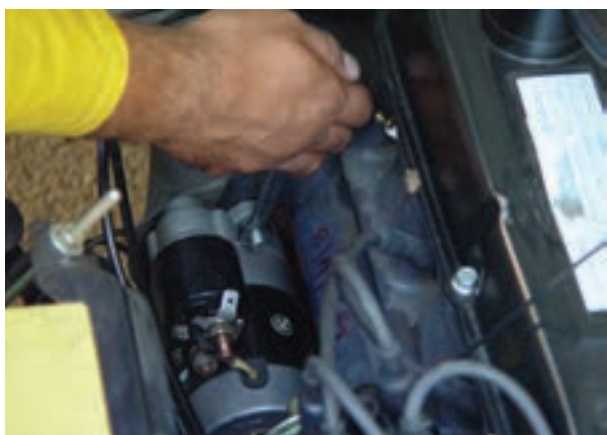
الف- باز کردن پیچ‌های استارتر
