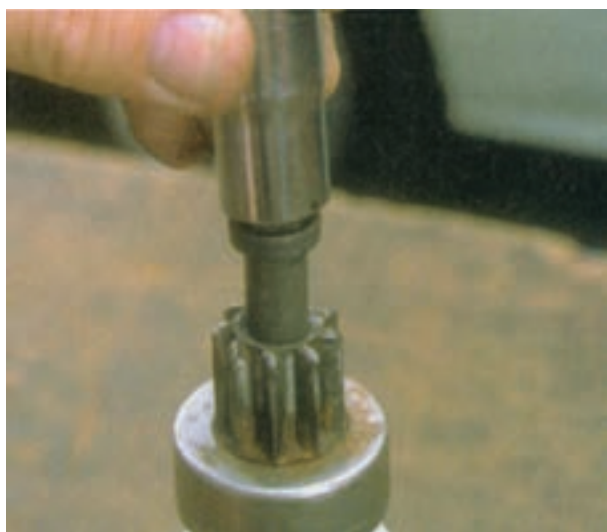
شکل ۸-۶۰ – خارج کردن حلقه رینگی از شیار شافت
