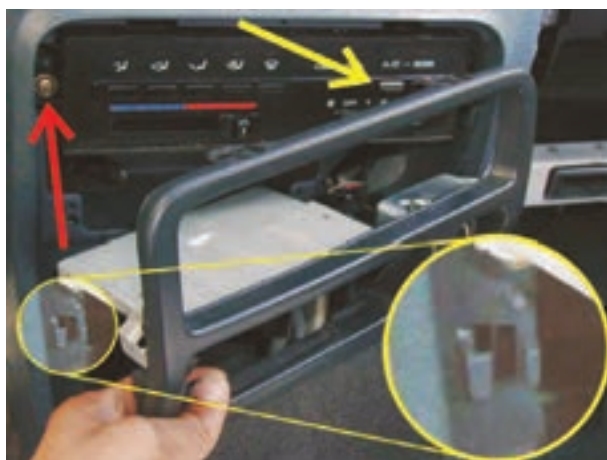
شکل ۳۸-۵- باز کردن قاب سوئیچ‌ها
