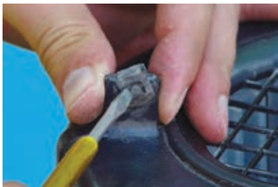
شکل ۴-۳۸- باز کردن ضامن خار
