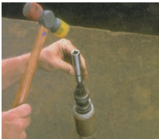
شکل ۸-۵۹ – ضربه زدن با چکش روی خار
