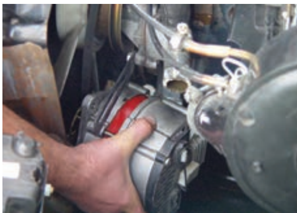
ب - بیرون آوردن آلترناتور از موتور شکل ۵۱-۶
