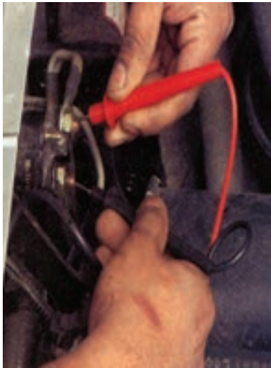
شکل ۸-۴۲- اتصال فیض‌های ولت‌متر به اتومات استارتر
