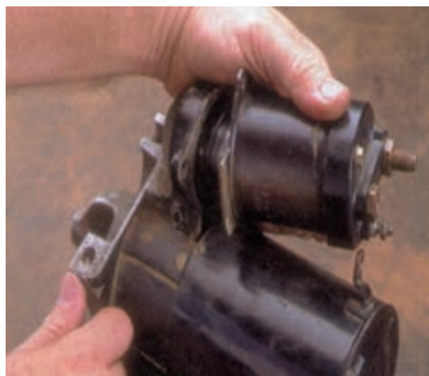
شکل ۸-۵۴ - خارج کردن اتومات
