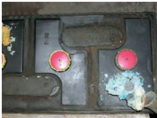
شکل ۱-۷۹ – سولفاته شدن قطب باتری
