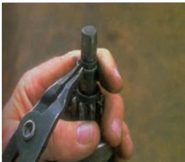
شکل ۸-۶۱ – درآوردن خار رینگی
