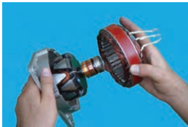
شکل ۶۲-۷ - جدا کردن استاتور
