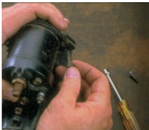
شکل ۸-۵۳ - بیرون آوردن پیچ‌های اتومات
