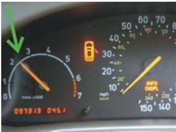
شکل ۳-۲۹- دور موتور در وضعیت آزمایش
