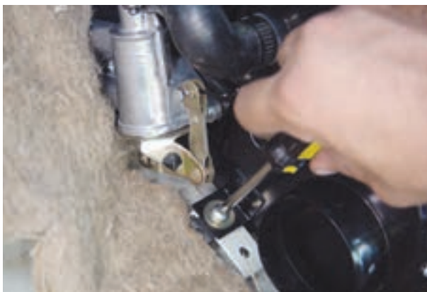
شکل ۴-۳۳- پیچ های پایه ی بخاری
