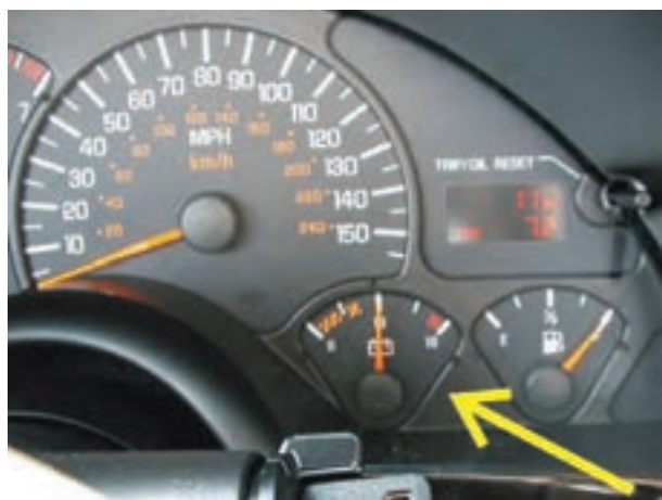
شکل ۱-۷۸ – نشان‌دهنده‌ی وضعیت شارژ باتری
