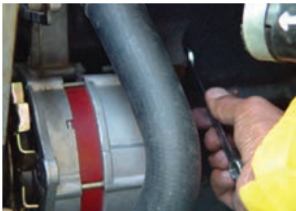
الف - بازکردن پیچ‌های پایه‌ی آلترناتور
