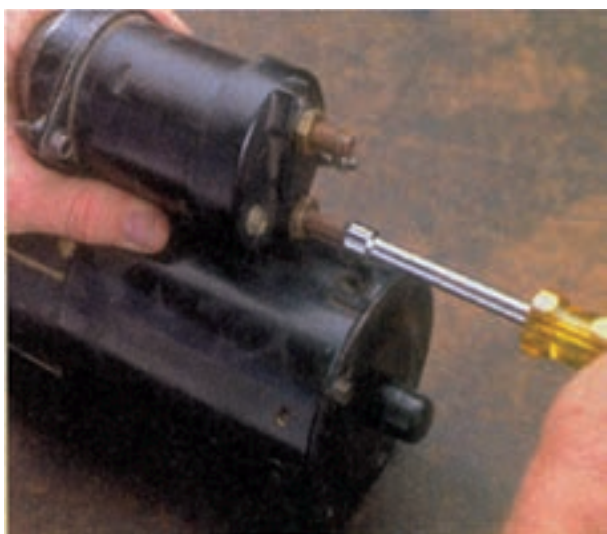
شکل ۸-۵۲ - باز کردن پیچ‌های اتصال اتومات به استارت
