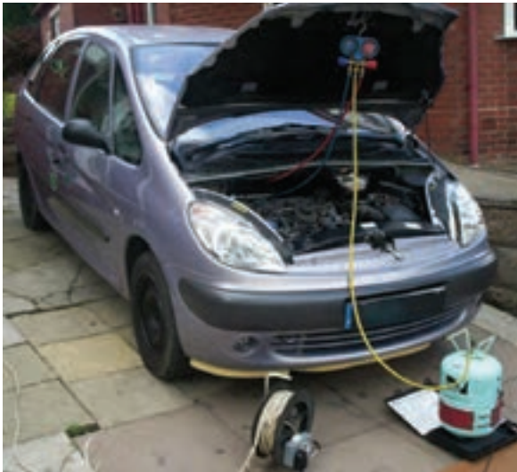
شکل ۳۵-۵ شارژ گاز کولر
