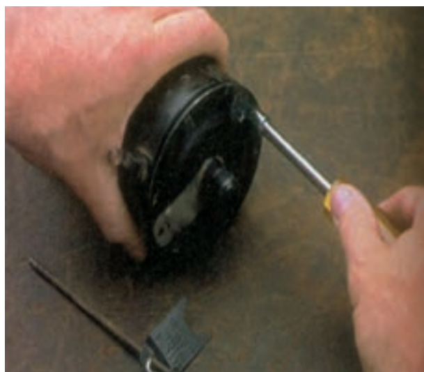
شکل ۸-۵۵ - باز کردن پیچ‌های اتصال درپوش به بدنه
