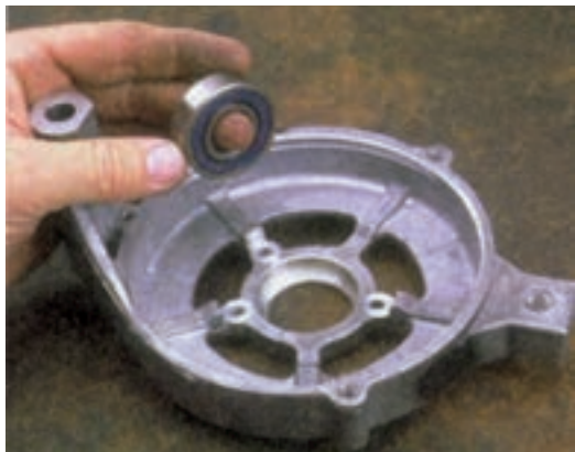
شکل ۷۰-۷ - خارج کردن بلبرینگ و آزمایش آن
