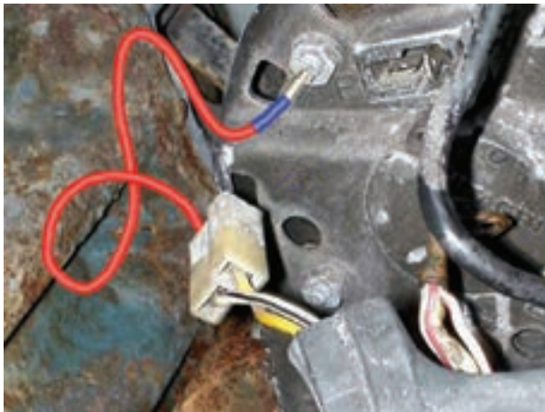
شکل ۳-۳۶- آزمایش مدار لامپ شارژ
