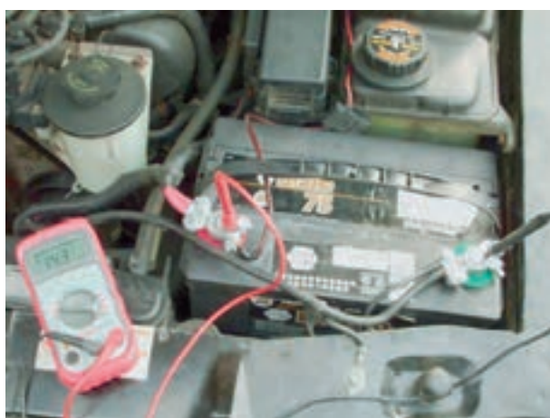
شکل ۷-۱۰۲- اندازه‌گیری ولتاژ شارژ
