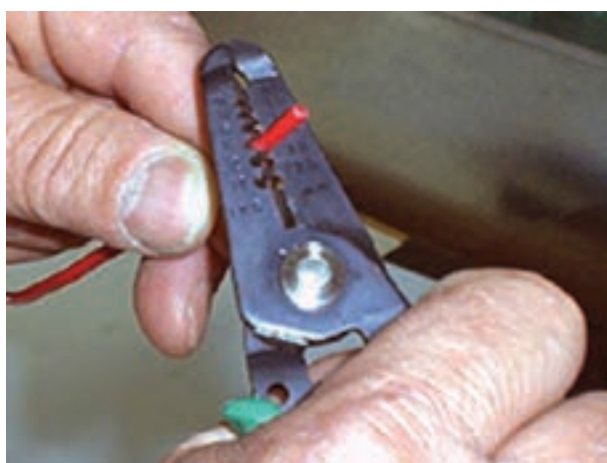
شکل ۳-۳۸- جدا کردن عایق سر سیم ها
