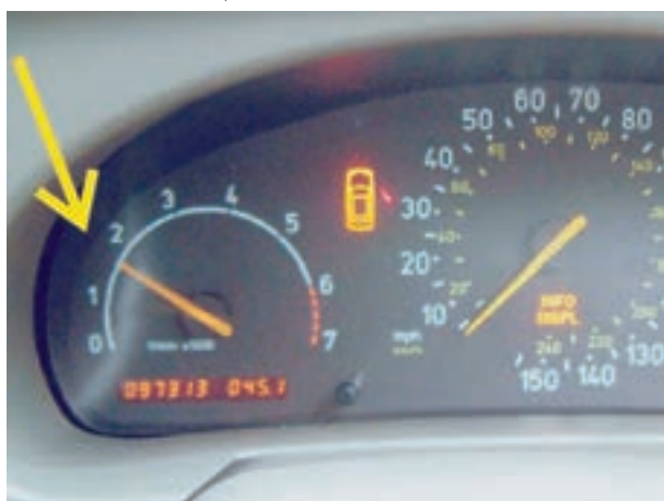
شکل ۷-۱۰۱- افزایش دور موتور برای آزمایش
