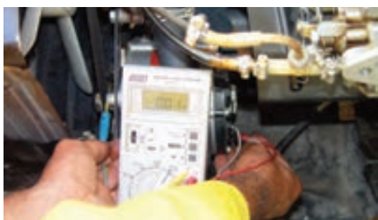
شکل ۷-۷۲ - اتصال ولت‌متر بین ترمینال B و بدنه
