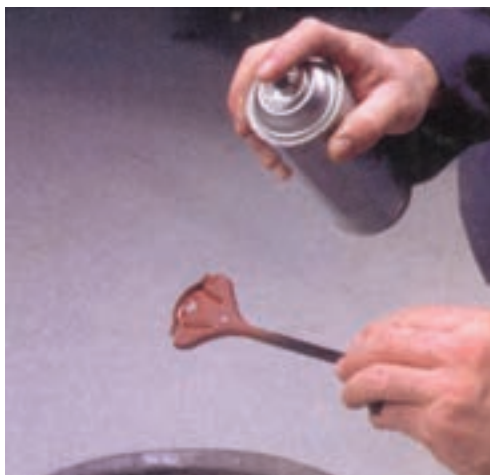
شکل ۹۳-۱- اسپری ضدخوردگی روی بست نگه‌دارنده‌ی باتری
