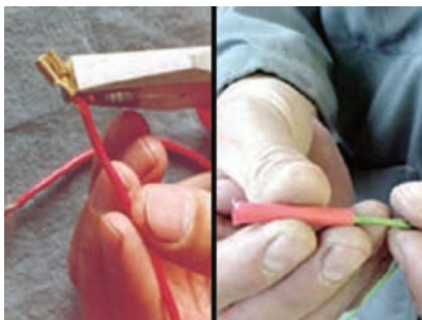
شکل ۴-۶۵- آماده کردن سیم‌ها
