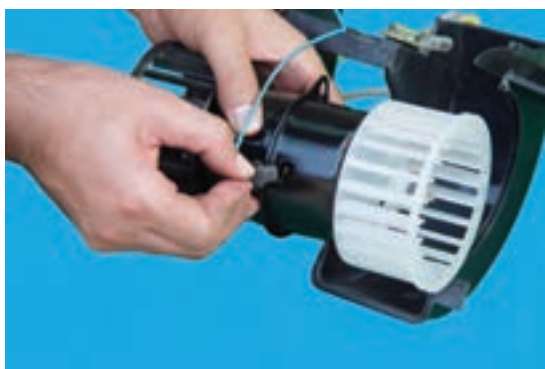
شکل ۴-۴۱- جدا کردن سیم از زغال‌ها
