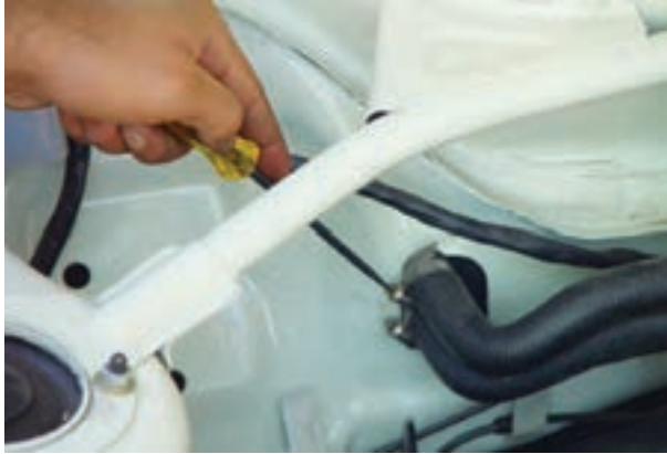
شکل ۴-۳۱- باز کردن لوله های آب رادیاتور بخاری
