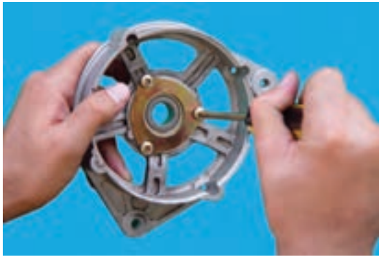
شکل ۶۷-۷ - باز کردن پیچ‌های نگه‌دارنده‌ی بلبرینگ
