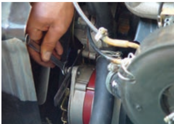
شکل ۷-۴۹ - باز کردن پیچ کشش تسمه پروانه
