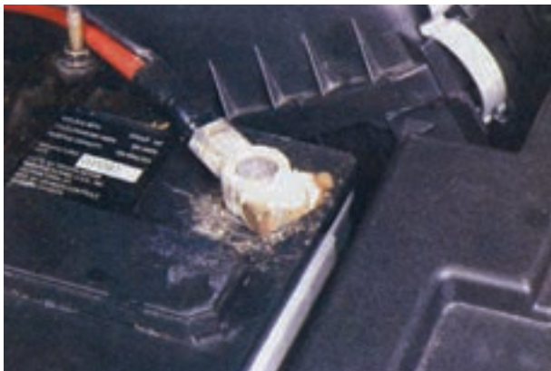
شکل ۳۱-۸ سولفات‌شدن اتصال قطب باتری
