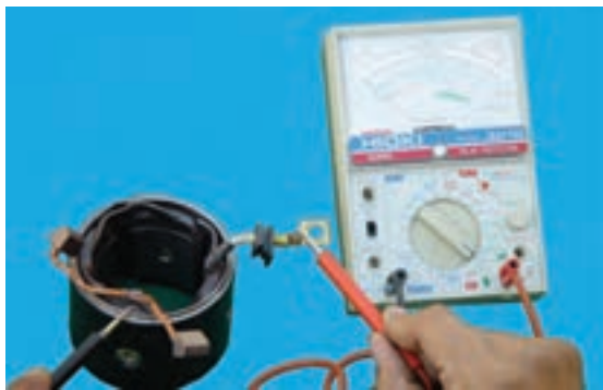
شکل ۸-۷۵- آزمایش اتصال بدنه‌ی بالشتک
