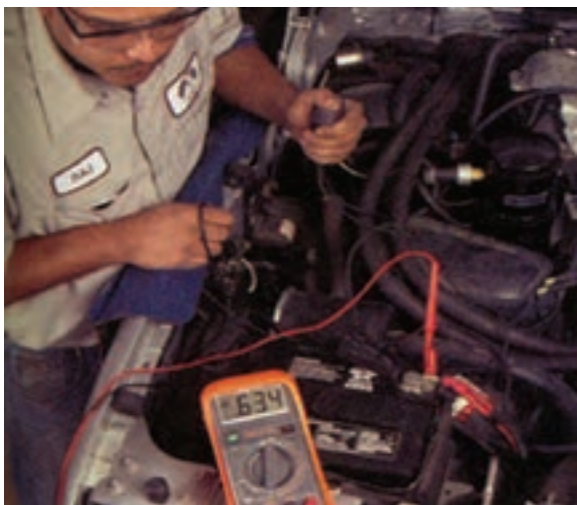
شکل ۸-۳۹- آزمایش افت ولتاژ باتری به خروجی رله
