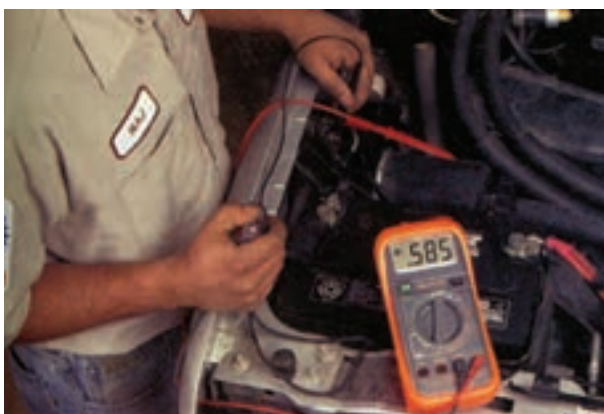
شکل ۸-۴۴- اندازه‌گیری افت ولتاژ پلاتین‌های سولونویید استارتر
