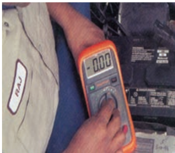
شکل ۸-۳۵- تنظیم مولتی متر روی شاخص ولتاژ
